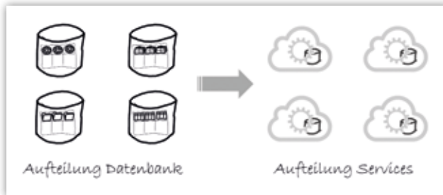
Aufteilung und Kapselung der Datenbank über Microservices (Abb. 4)
